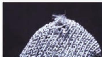
Der Einsatz von Glasfasern zum Erreichen höherer Schnittschutzeinstufungen verlässt sich auf die empfindliche Struktur von Endlos-Glasfilamenten. Neben reduzierter Schnittfestigkeit kann Glasfaserbruch den Tragekomfort und die Einhaltung geltender Sicherheitsvorschriften beeinträchtigen.
